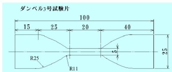
試験片形状:ダンベル3号型
